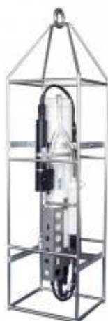
Figura 2.1: CTD Seabird-SBE19-Plus V2. Fuente: www.seabird.com/sbe19plusv2-seacat-ctd
