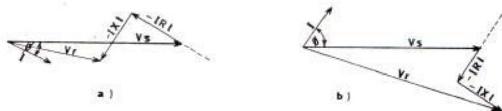
Fig 2.3 DIAGRAMAS FASORIALES, a) FACTOR DE POTENCIA RETRASADO y b) FACTOR DE POTENCIA ADELANTADO
