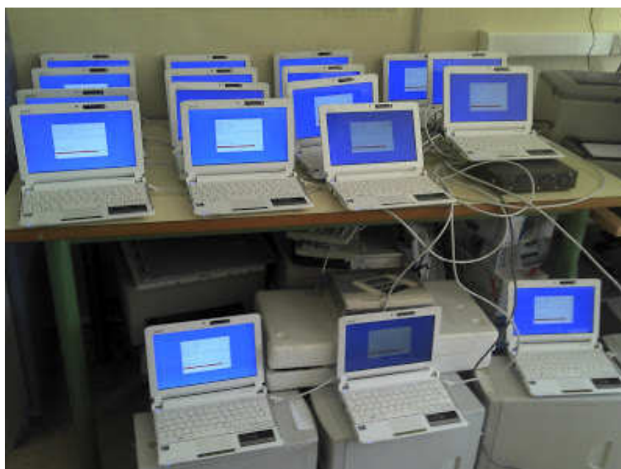
Figura 2.28 Clonezilla Server Inicio de proceso de clonación en red por multicast y pxe
