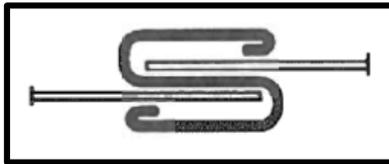
**Figura 2.9** Unión Transversal tipo S-Slip
