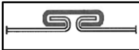
**Figura 2.10** Unión Transversal tipo Drive-Slip
