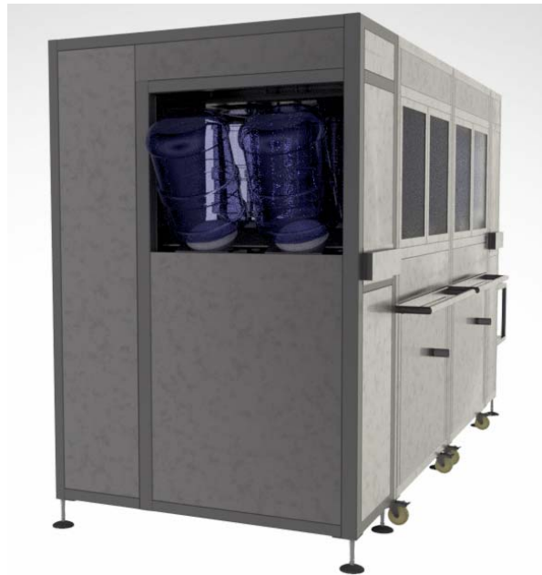
Figura 3.1. Diseño final de la maquina lavadora de bidones
