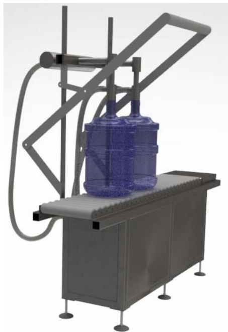
Figura 3.6. Diseño final de la maquina llenadora de bidones
