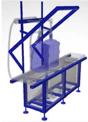
Figura 2.29. Sistema estructural de la llenadora de bidones
