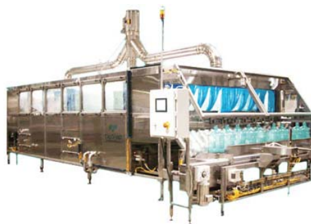
Figura 1.6. Lavadora automática lineal
