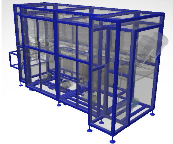
Figura 2.18. Sistema estructural de la lavadora de bidones
