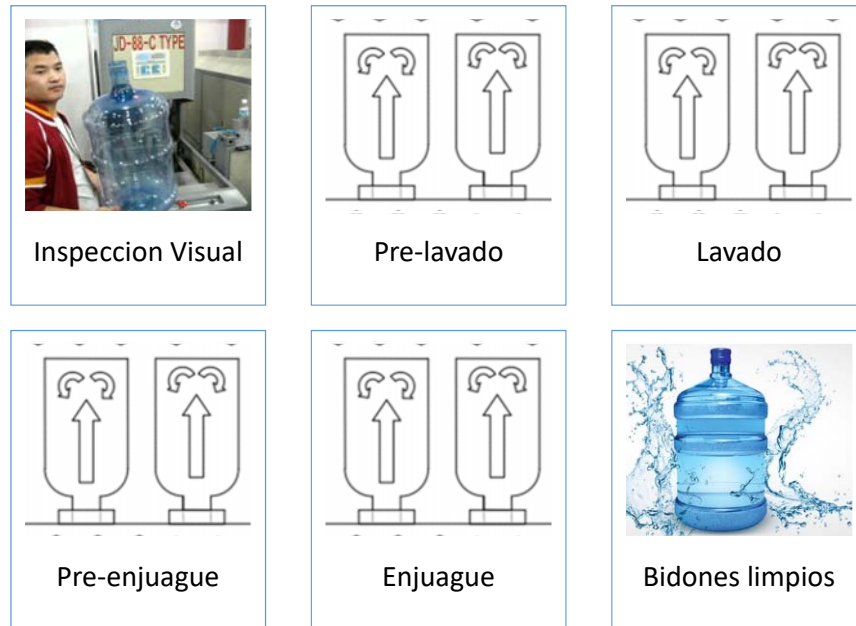
Figura 1.1. Diagrama del proceso de lavado.
