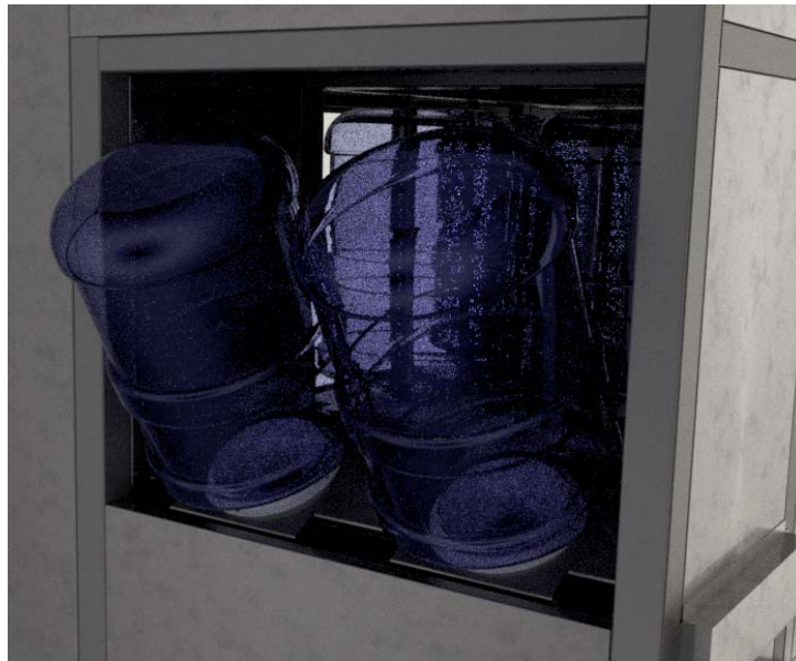
Figura 3.4. Detalle del ingreso de los bidones a la lavadora
