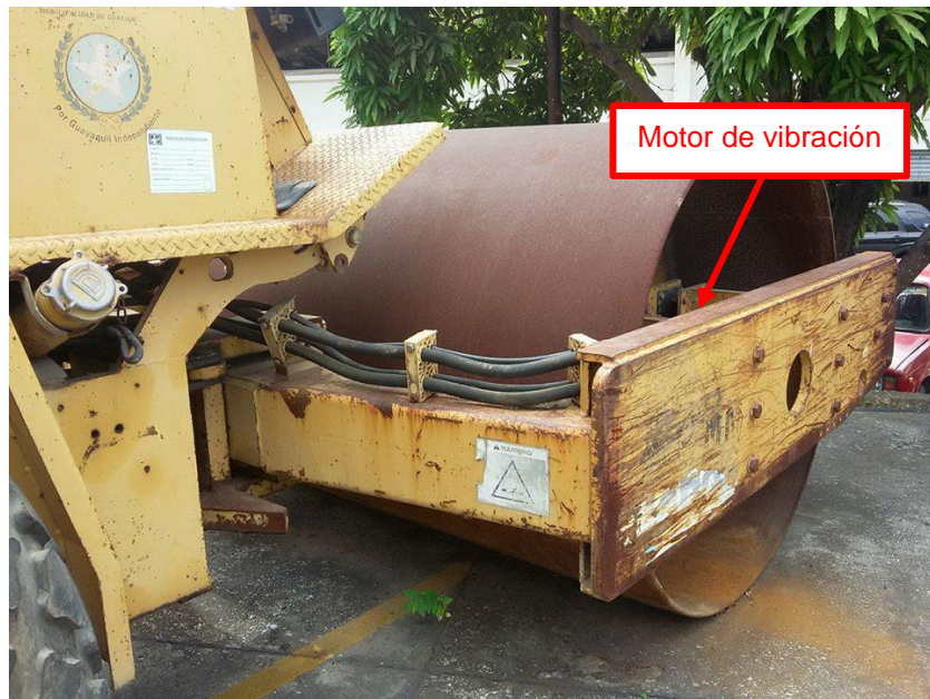
Figura 3.25 Líneas de aceite hidráulico conectadas al motor de vibración.
