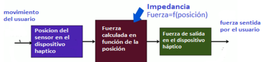
Figura 1.12 Sistema de Retroalimentación por Impedancia del Dispositivo
