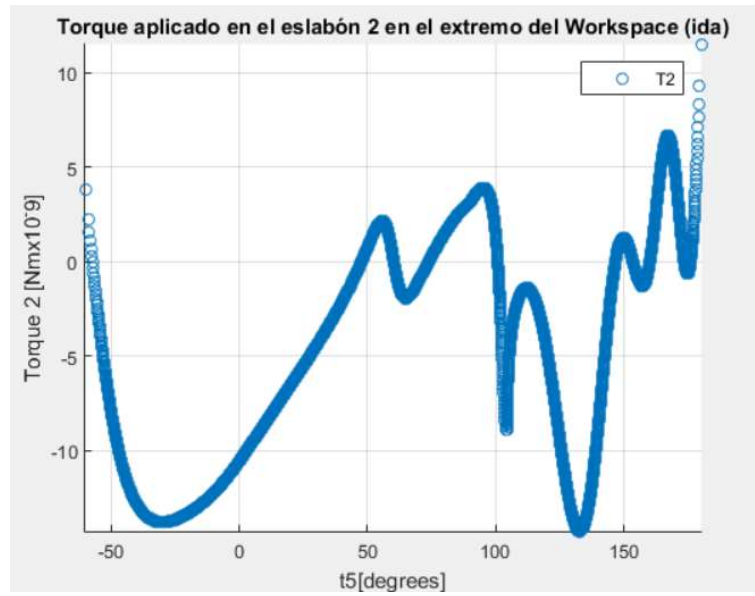
Figura C.17 Torque T_2 en el recorrido de ida en el extremo del espacio de trabajo
