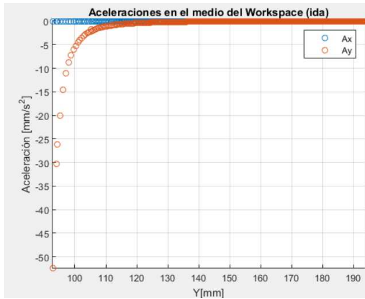
Figura C.10 Aceleración del punto operacional en el recorrido de ida en la mitad del espacio de trabajo
