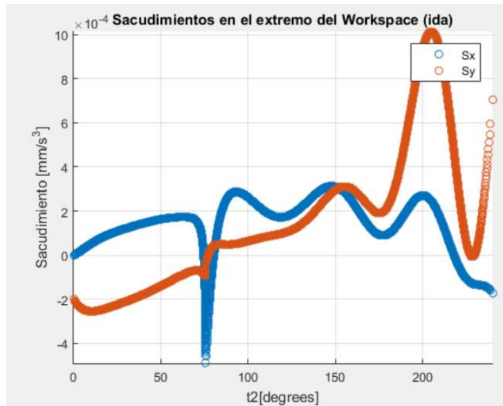
Figura C.4 Sacudimiento del punto operacional en el recorrido de ida en el extremo del espacio de trabajo
