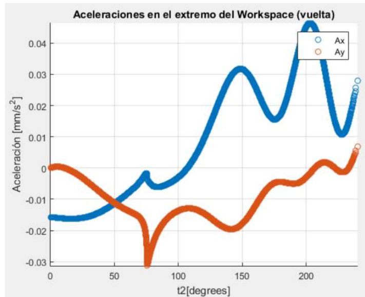
Figura C.6 Aceleración del punto operacional en el recorrido de vuelta en el extremo del espacio de trabajo
