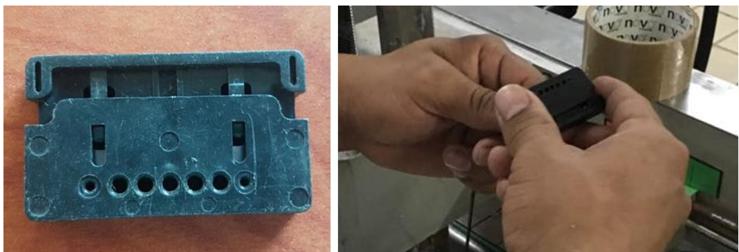
Figura 2.23 Guillotina para cortar fibra óptica
