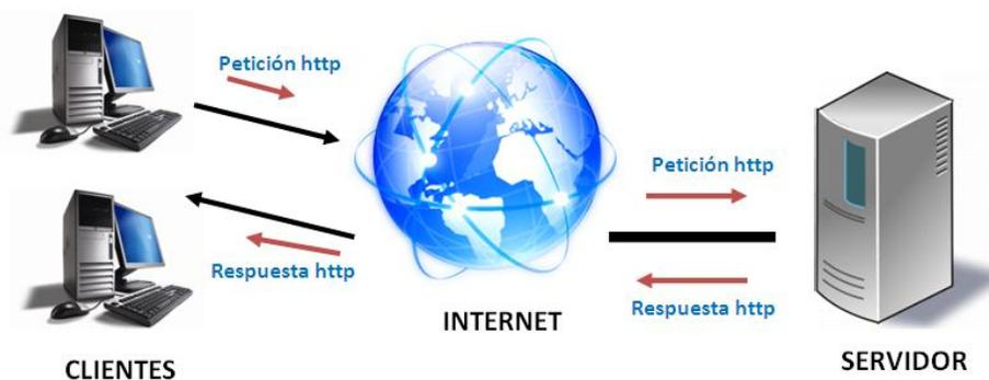
**Figura 2: Modelo de Organización Arquitectónica Cliente – Servidor [4].**
