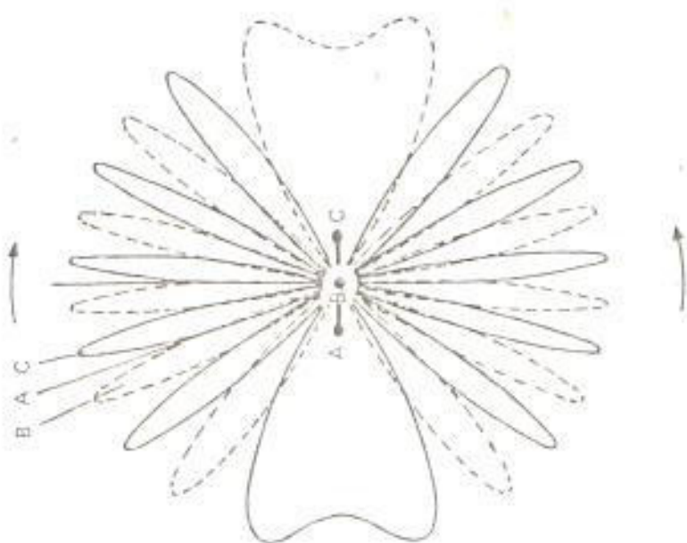
Fig. 3.26 DIAGRAMA DE RADIACIÓN "CONSOL"
