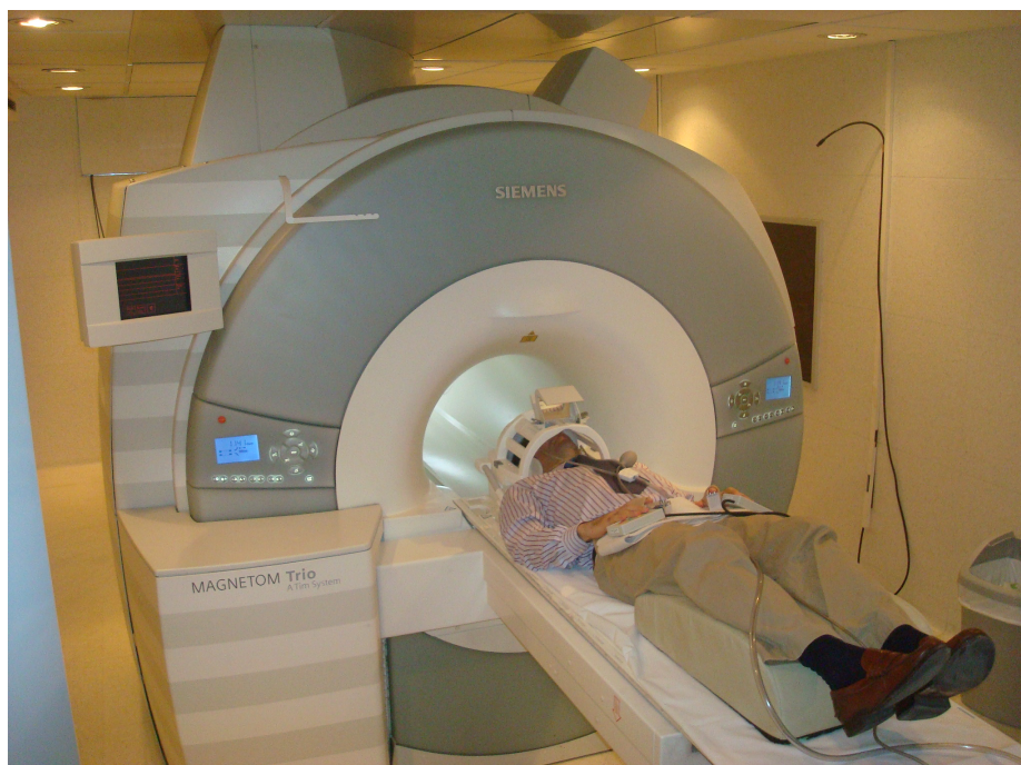
Figura 2-1 Trio-TIM, Siemens 3T RM scanner, equipado con una bobina de cabeza de 12 canales. Cortesía: Clínica Universidad de Navarra, Pamplona, España.
