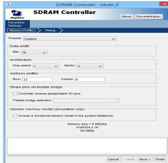
**Figura 3.15 – Componente SDRAM Controller.**
