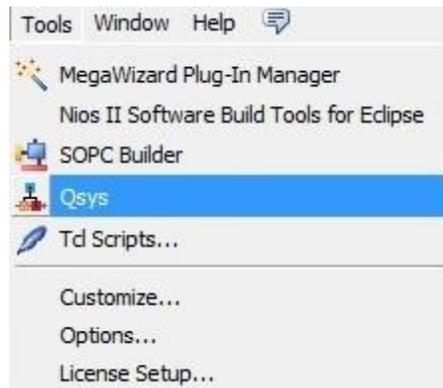
**Figura 3.12 – Ventana para abrir la herramienta QSYS.**
