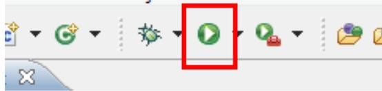
**Figura 3.65 – Ejecutar la aplicación en la tarjeta DE2.**
