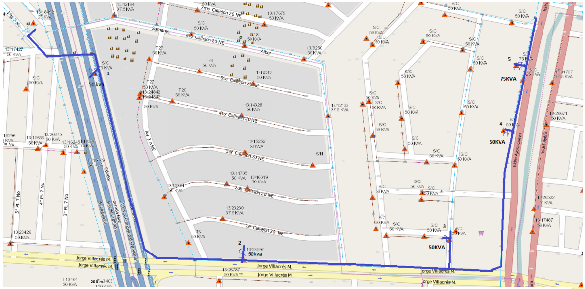
Figura 5.3 Recorrido 6 puntos de protección de Alimentadora Samanes 4
