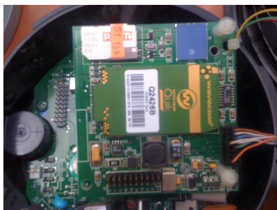
FIGURA 4.1. EQUIPO COMUNICACIÓN INTERNA GPRS Elaborado por: Eddie Calderón M., 2005
