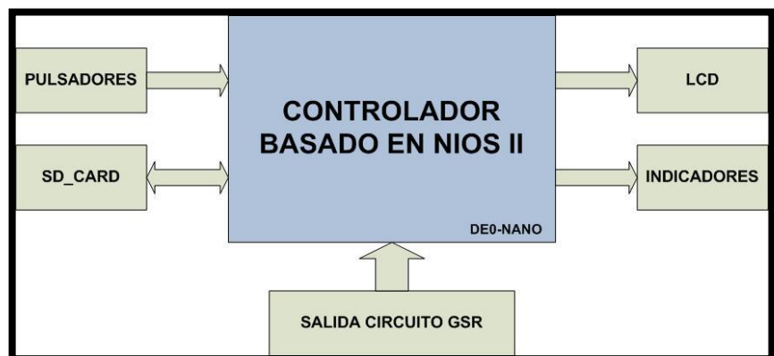
Figura 3.8 Integración componentes con el controlador
