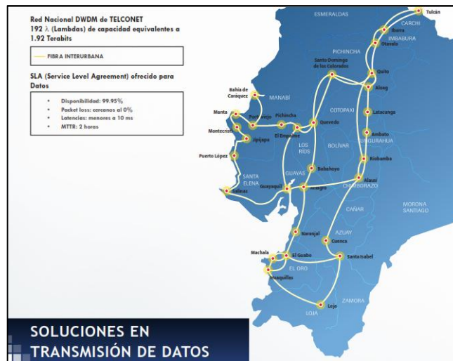
Figura 4.23 Red de fibra óptica de TELCONET S.A. en Ecuador
