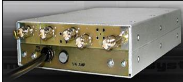
Figura 5.32 Distribuidor de Video Digital DVA2604 1x4 [50]
