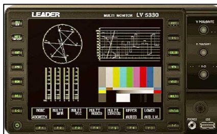
Figura 5.26 Analizador de señales LEADER LV 5330 MULTI-SDI TEST [44]
