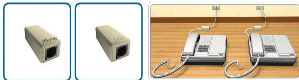
Figura 19.- Rol del Microfiltro de un puerto [24]
