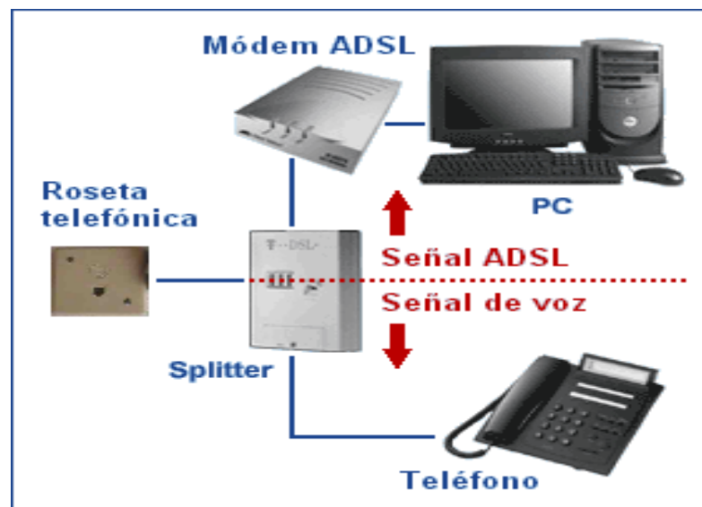
Figura 4.- Uso splitter para evitar atenuación [5]
