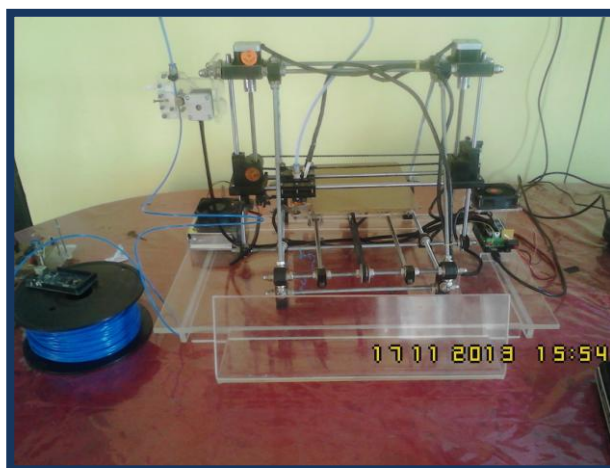
Figura 2.13 Impresora 3D Prusa Mendel armada.
