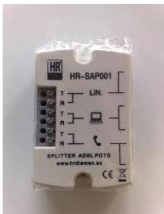
**Figura 4-8 Splitter utilizado en los abonados [11]**
