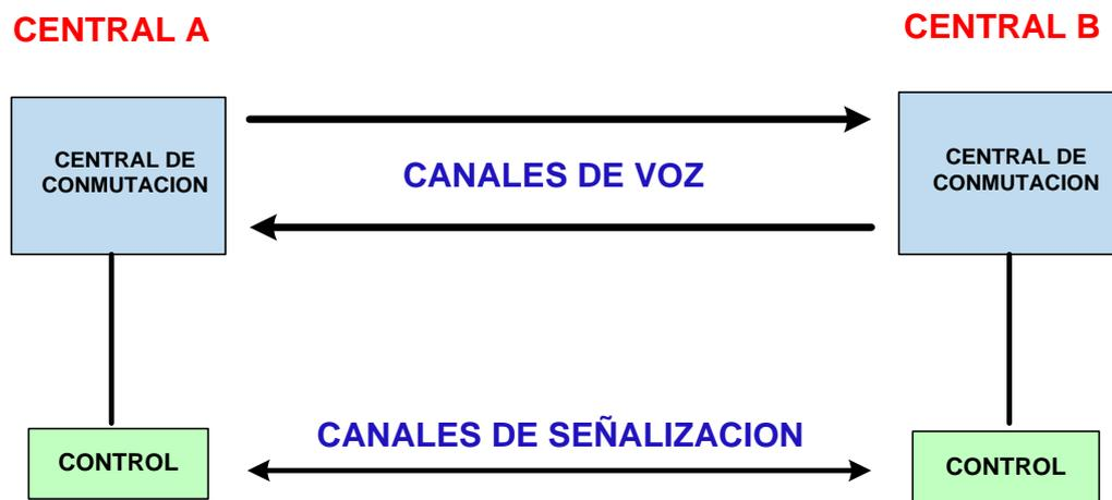
**Figura 1.2 Señalización por Canal Común [3]**
