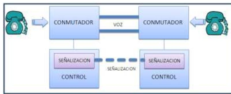
Figura 1.2 Señalización por Canal Común [1]
