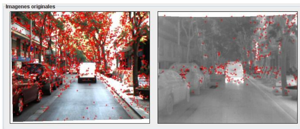
Figura 5.6 Incremento de puntos de interés en imagen IR
