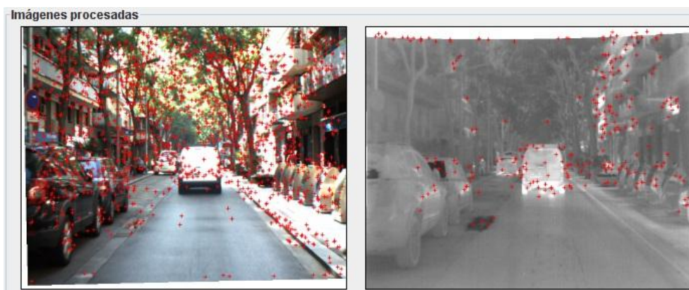
Figura 5.10 Detección de puntos de interés para un valor de hessianThreshold= 200
