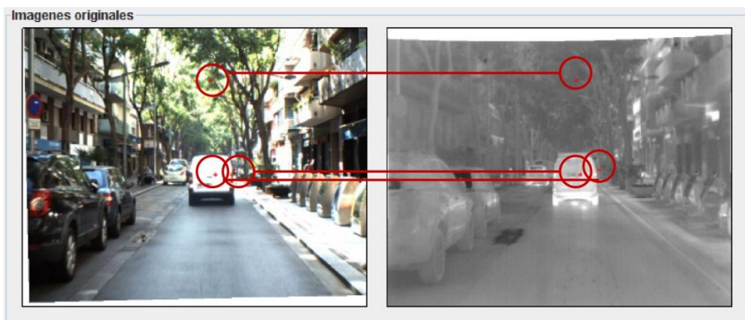
Figura 5.5 Comparación de imágenes con sus puntos de correspondencia (con un círculo se indican los puntos detectados y correctamente correspondidos).
