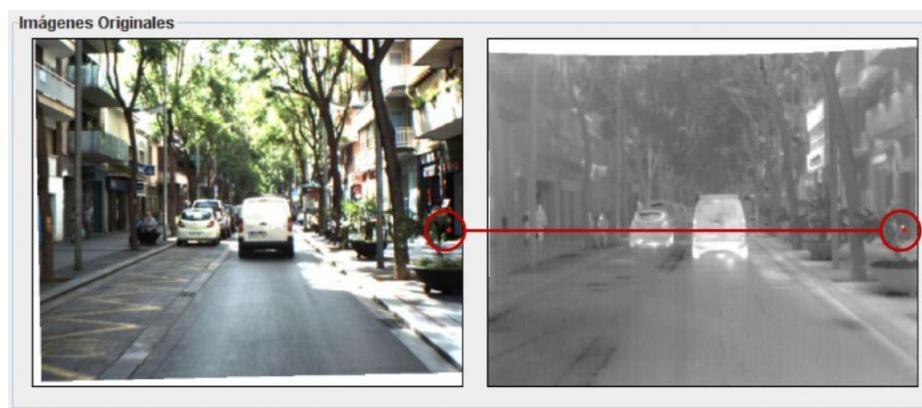
Figura 5.9 Comparación de imágenes con sus puntos de correspondencia (con un círculo se indican los puntos detectados y correctamente correspondidos).
