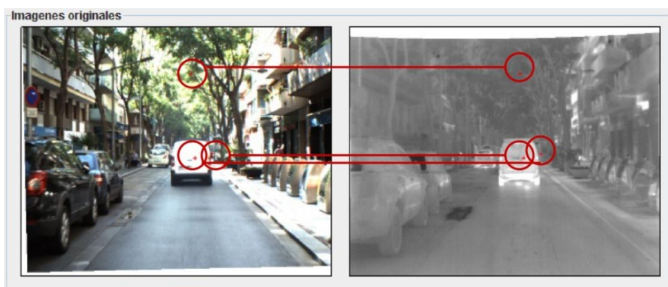
Figura 5.7 Correspondencia de puntos para un valor del ContrastThreshold= 0.02
