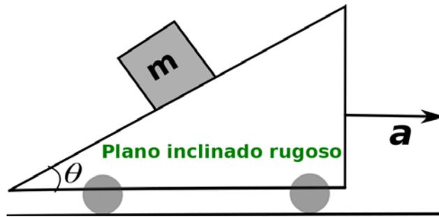
Solución: Como nos piden la aceleración mínima, esto se logra haciendo que el roce estático entre el bloque y el plano tenga su valor máximo  $f_s = \mu_s N$ . Escogiendo un sistema de coordenadas que tenga su eje x a lo largo del plano, se encuentra que la aceleración tiene las componentes
