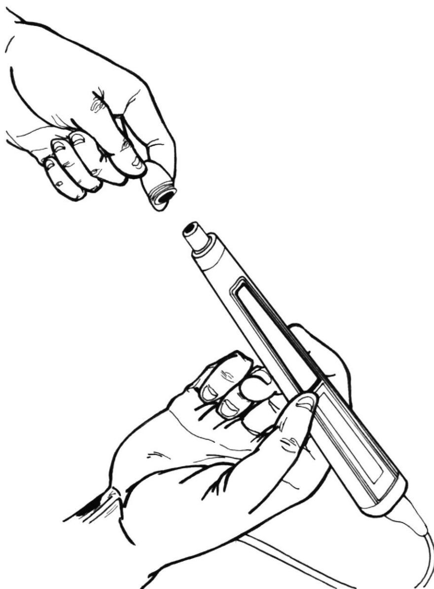
Fig. N° 3.7 Desenroscamiento de la Pluma lectora de Barras
