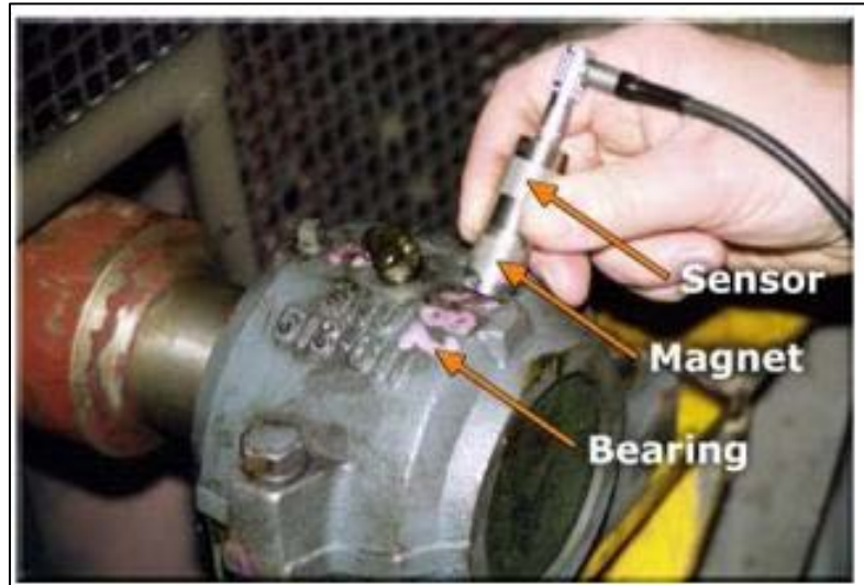
Fig.22 Análisis vibracional de elementos rodantes de soporte de eje
