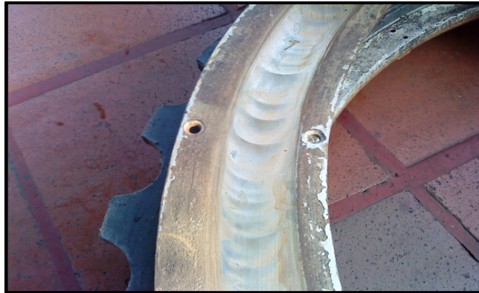
Fig. 12 Guía de deslizamiento desgastada
