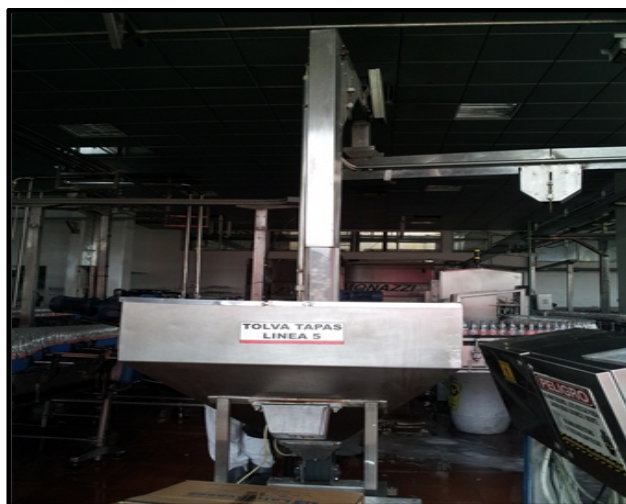
Fig. 16 Mejoras en el diseño de la tolva y transporte de tapas
