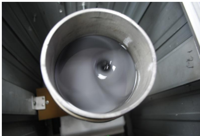
Figura 4.2 Se muestra el calibrador de baño sin tapa, donde se puede apreciar el flujo circulatorio generado por el agitador.
