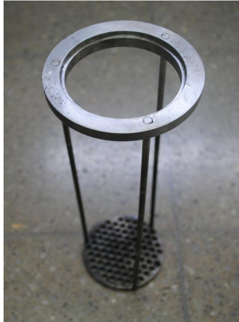
Figura 4.4 Estructura con rejilla en la parte inferior.
