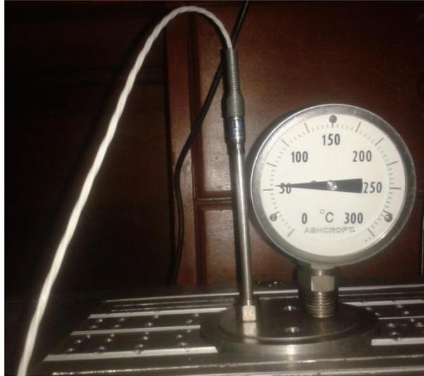
Figura 5.3 Termómetro calibrando en el punto 55°C.
