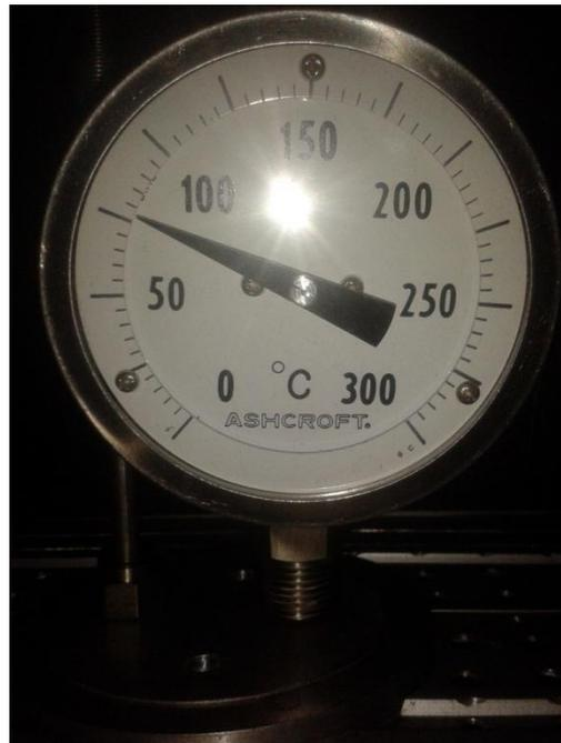
Figura 5.2 Termómetro calibrando en el punto 75°C.
