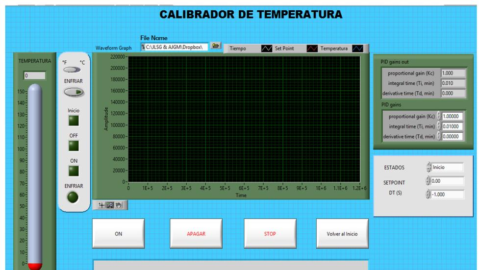
Figura 2.21 VI del Panel Frontal del calibrador de temperatura
