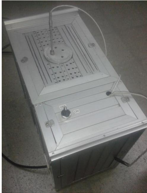
Figura 2.13 Vista externa del calibrador de Temperatura
