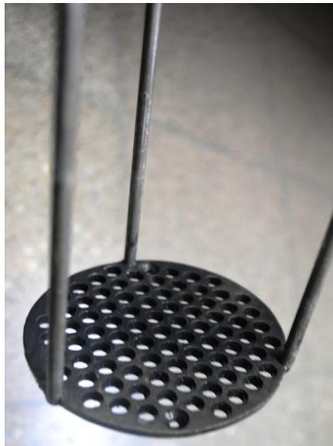
Figura 4.5 Rejilla para calibrador de temperatura.
