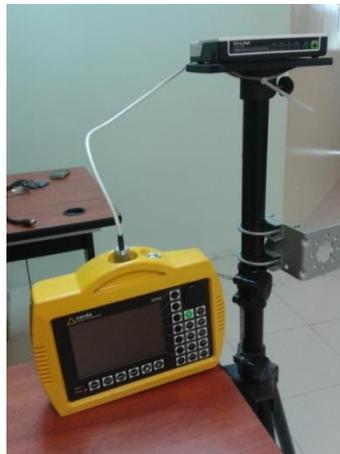
Los resultados obtenidos se pueden apreciar en la figura, donde el punto de acceso alcanzó una potencia de 16.75 dBm.
