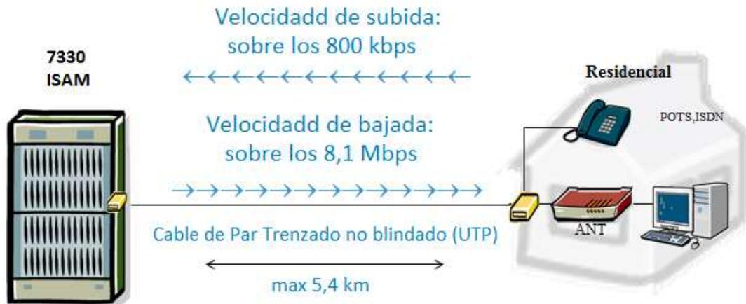
Figura 2.4: Esquema básico de una red ADSL [8]
