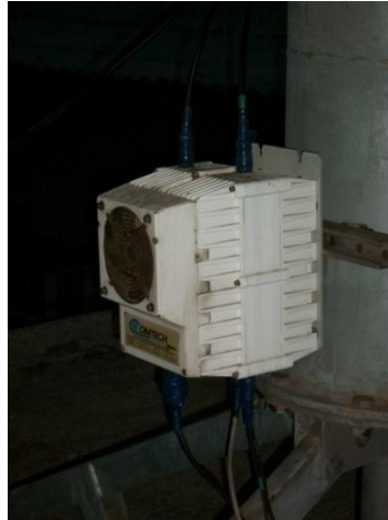
Figura 3. 8: Transceptor de potencia de 10 watts.
