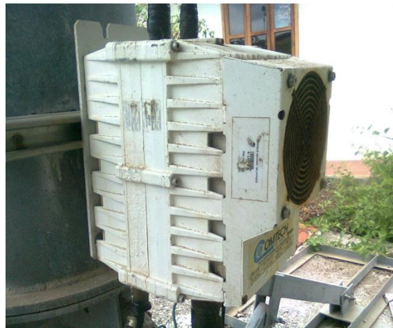
Figura 3. 11: Transceptor de potencia de 5 watts.
