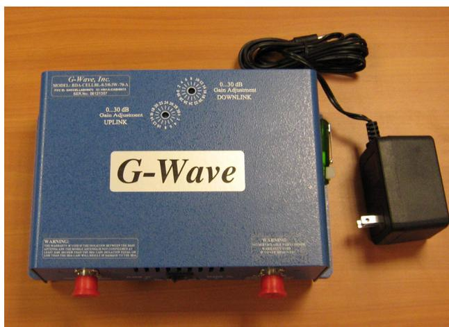
**Figura 2.13 Repetidor celular**
