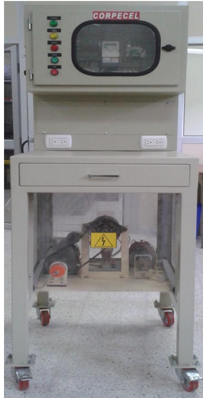
Figura 4.1 Banco de prueba del sistema frecuencia-voltaje
