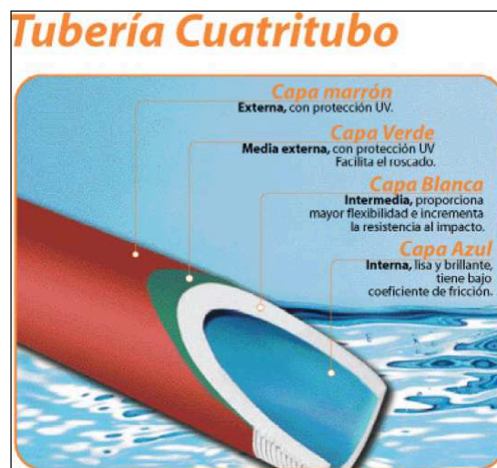
Figura 2.10. Tecnología de la Línea Roscable de Polipropileno
