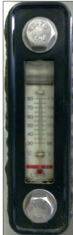
Figura 1.7. Visor del Nivel de Agua del Reservorio
