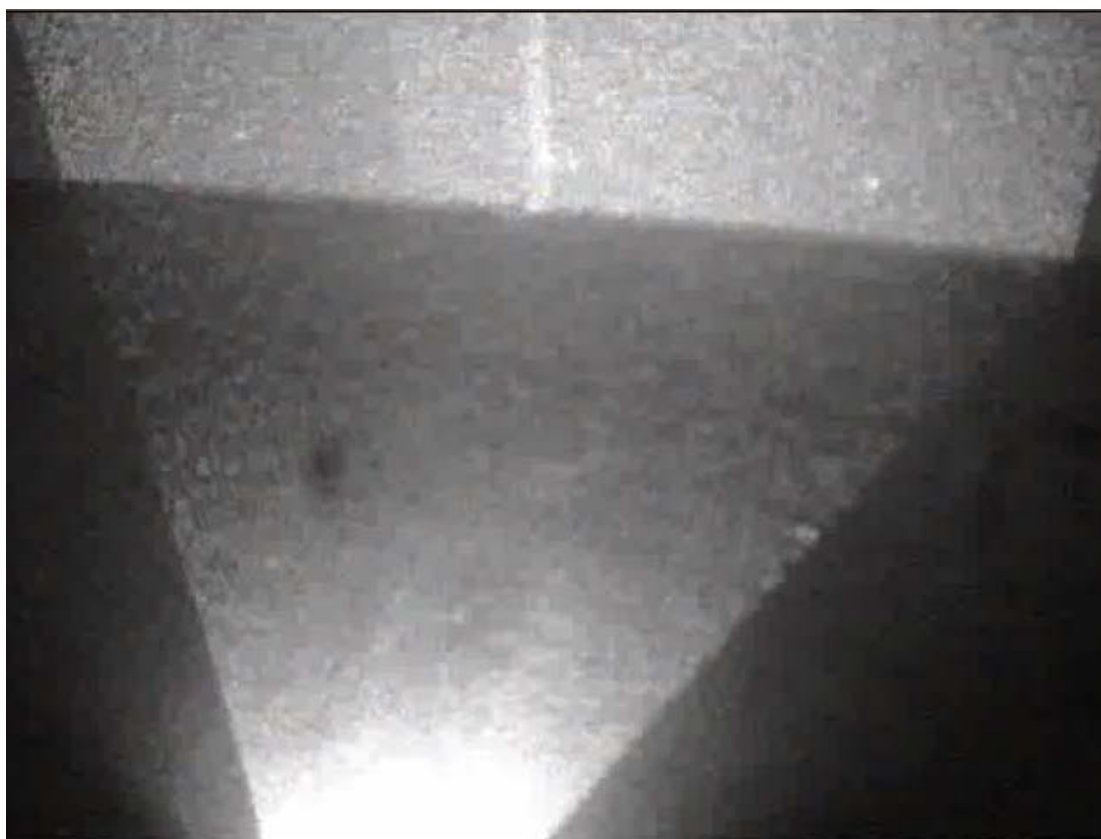
Figura 4.17 Haz de luz que proyecta el Kinect vista desde una cámara infrarroja
