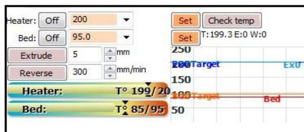
Figura 2.10. Calibración y monitoreo de parámetros en Pronterface
