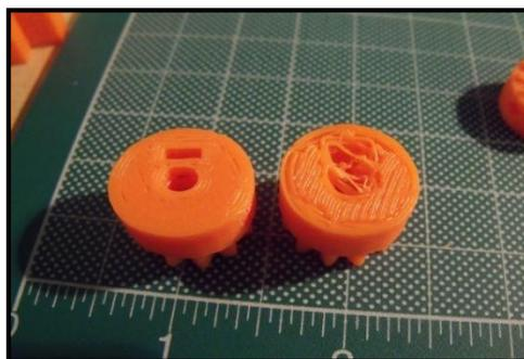
Figura 2.8. Pieza 3D impresa con Marlin y Sprinter [30]
