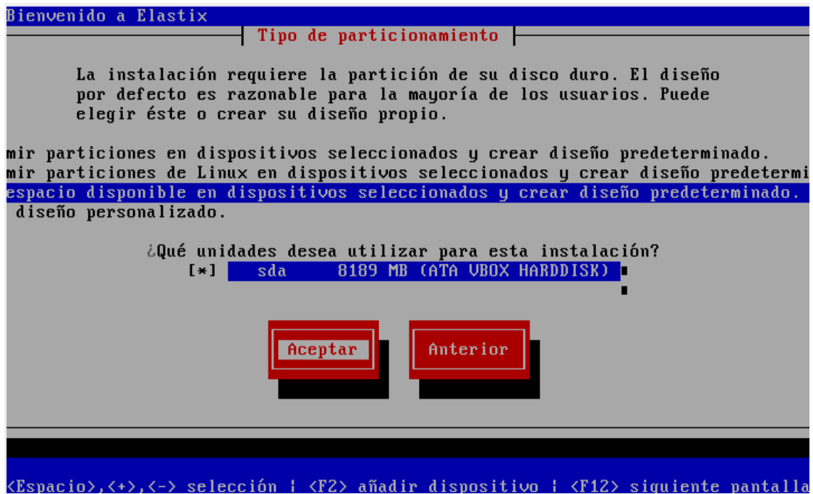
Figura C. 5 Instalación de Elastix: Selección de disco duro
