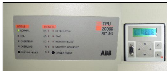
Fig. 4.16 Dispositivo Electrónico Inteligente de Protección
