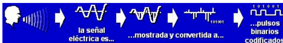
FIGURA 4.8. SEÑAL ANÁLOGO A SEÑAL DIGITAL
