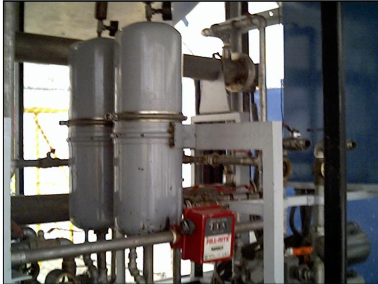
FIGURA 5.5. FILTROS DE CARTUCHO Y MEDIDOR DE FLUJO
