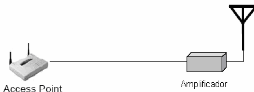
Fig. 1.27 Diagrama básico para la conexión de un amplificador.
