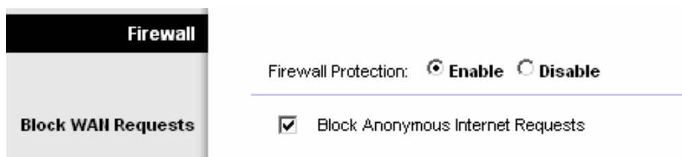
Fig. 2.45 Activación del Firewall de protección en Router Linksys.
