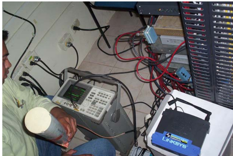
Fig. 2.29 Medición de potencia irradiada por el equipo WRT54-G Linksys.
