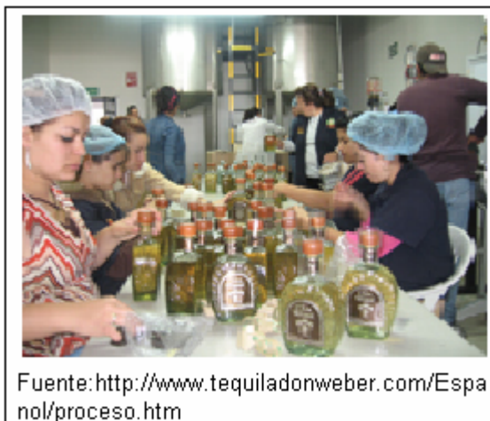
Figura 1.2 Colocación manual de etiqueta
