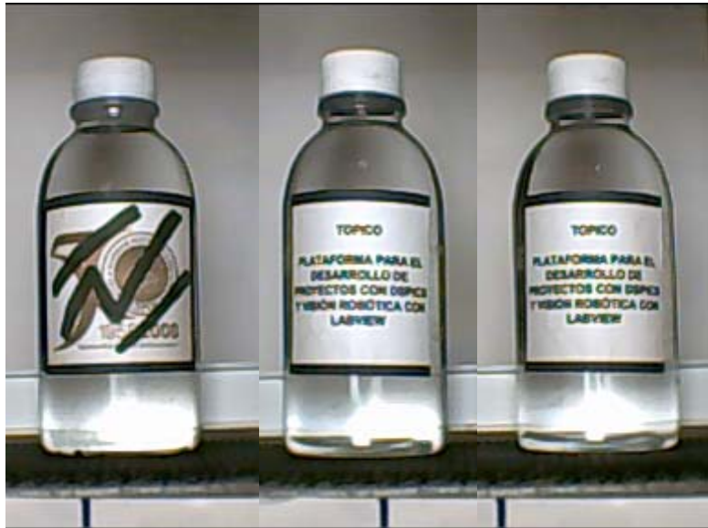
Figura 5.2 Imágenes donde se aprecia el desfase en la detención de los frascos.
