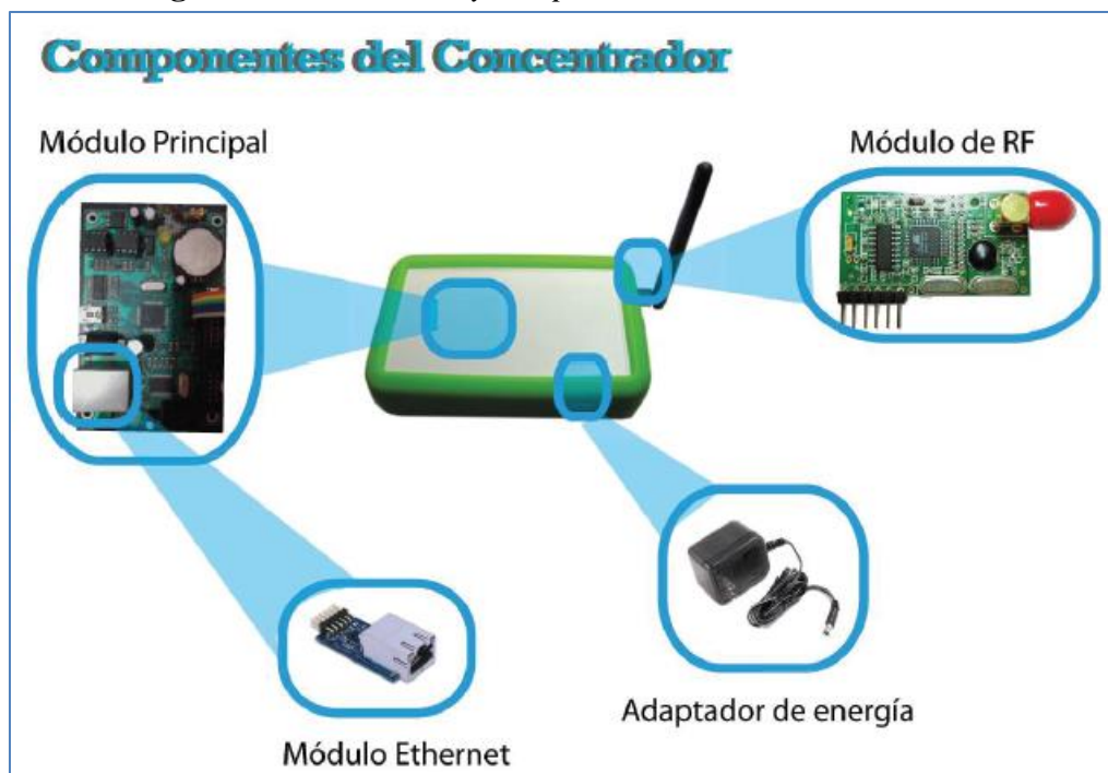
Figura No. 17: Diseño y componentes del Concentrador
