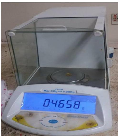
**Figura 2. 15. Pesaje de las muestras para pruebas de hinchamiento al tolueno**
