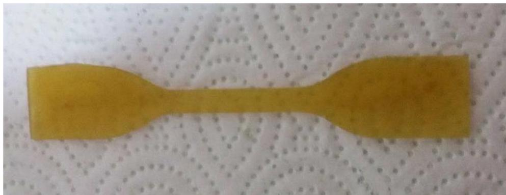
**Figura 2. 12. Probeta utilizada en el ensayo de tensión**
