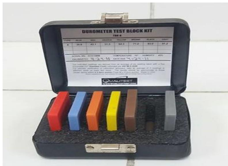
**Figura 2. 10. Kit de bloques utilizados para la calibración del durómetro**
