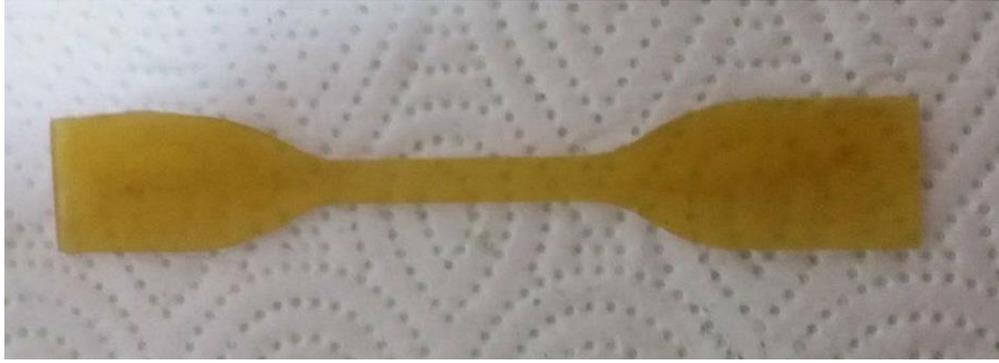
**Figura 1. 13. Probetas para la prueba de tensión**
