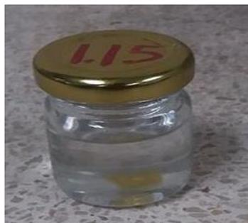
**Figura 2. 14. Muestras para la prueba de Hinchamiento en tolueno**
