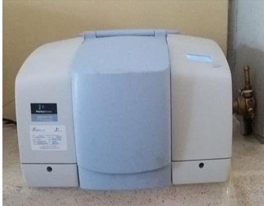
**Figura 2. 5 Equipo utilizado para el ensayo de FTIR (Espectrofotómetro)**
