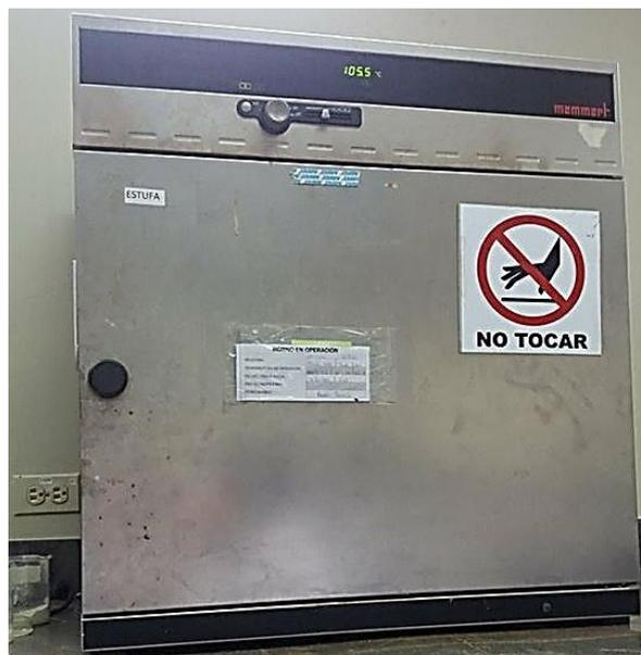
**Figura 2. 3. Horno usado en el curado de las muestras.**
