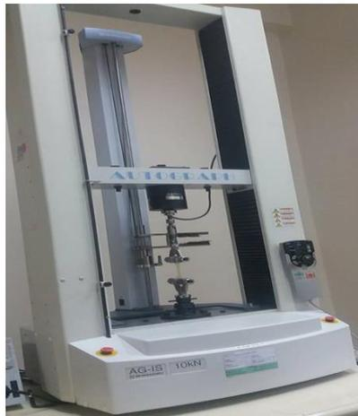
**Figura 2. 11. Máquina Universal de Ensayos**
