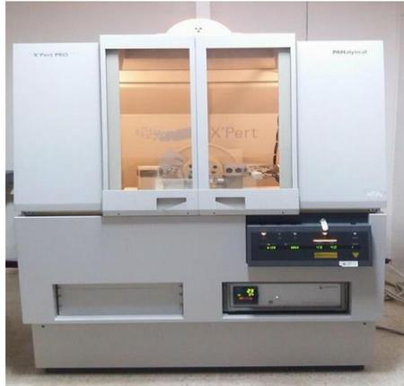
**Figura 2. 7. Difractómetro de Rayos X**
