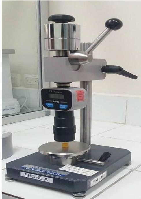
**Figura 2. 9. Durómetro Shore A**
