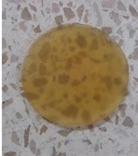
**Figura 2. 8. Muestra preparada para el ensayo XRD**
