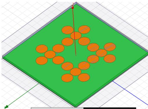
**Figura B.7: Arreglo Plano de 4 (2x2) elementos**
