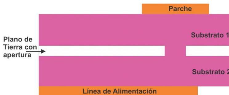
**Figura 2.3: Antena parche de alimentación acoplada por apertura.**
