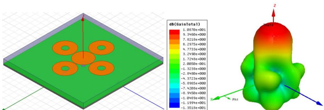
**Figura 3.13: Diseño de la antena con el parche y su respectivo patrón de radiación originado con el 90% del área de los elementos parásitos.**
