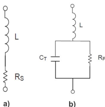
**Figura 2.8: Modelo electrónico del diodo pin: a) Polarización Directa (Estado “On” Encendido), b) Polarización Inversa (Estado “Off” Apagado).**
