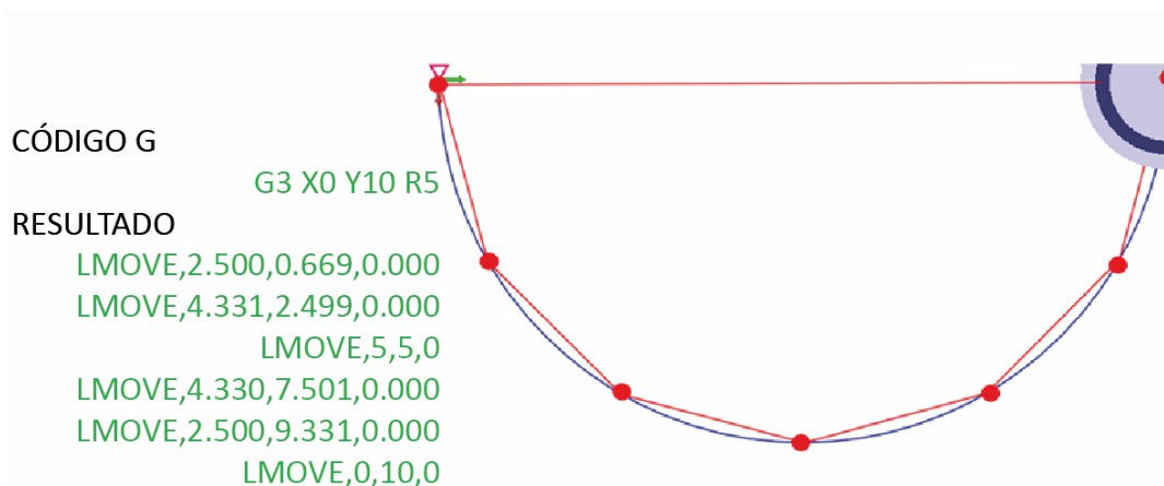
Figura 3.16: Interpolación de puntos a través de trayectoria circular con un paso de 30 grados.
