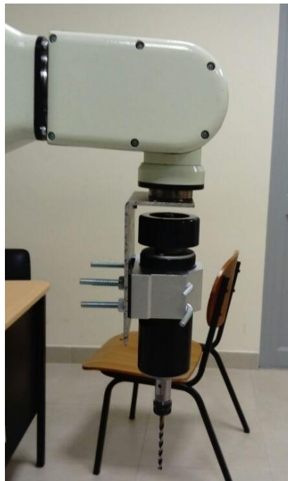
Figura 3.22: Montaje del Motor en el Brazo Robot.
