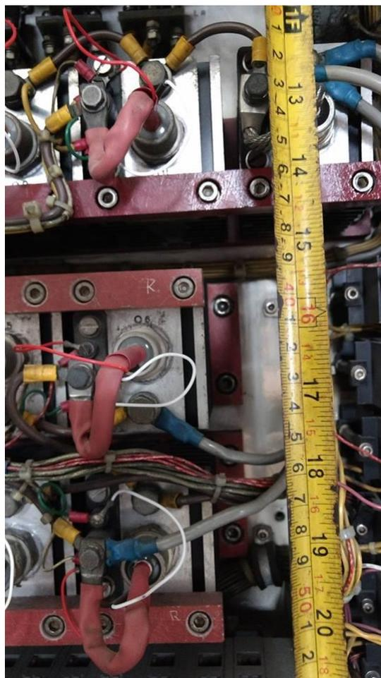
**Figura 4.7: SCR montados y listo para retirarlos por falla.**
