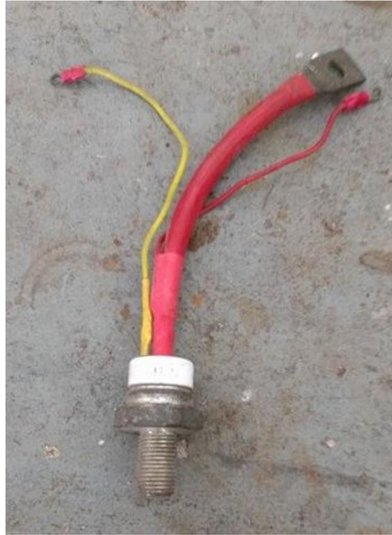
**Figura 4.3: Rectificador Controlado de Silicio SCR 36A160.**
