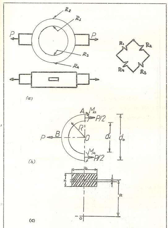
FIG. 2.4 DINAMOMETRO TIPO ANILLO, (a) INSTRUMENTACION, (b) DIA-GRAMA DE CUERPO LIBRE, (c) DETALLE DE LA SECCION DEL ANILLO.
