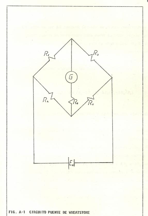
En razón de ser  $\Delta R$  bastante pequeño se emplea generalmente un circuito puente de Wheatstone para medir su valor. En la figura A-1 se muestra un dispositivo puente de Wheatstone.  $R_1$ ,  $R_2$ ,  $R_3$  y  $R_4$  pueden ser extensómetros eléctricos, G es un galvanómetro, debido a deformación producida sobre ellos ocurre un  $\Delta R$ , se puede demostrar empleando las leyes de Kirchhoff que
