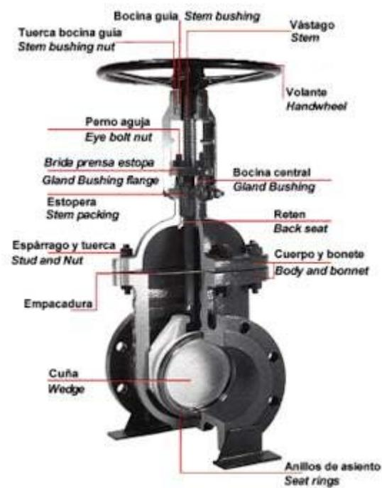
**Figura 1-2 Características de la válvula de compuerta**
